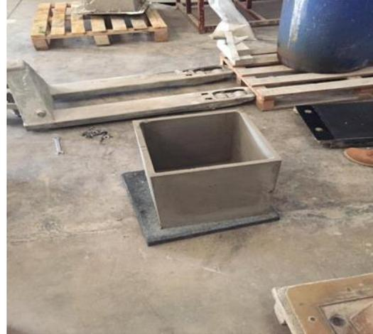
**AggreCrete** funcionó positivamente actuando como aglomerante y creó una estructura sólida y resistente que permitió demoldar a las 24 horas sin roturas ni grietas.
